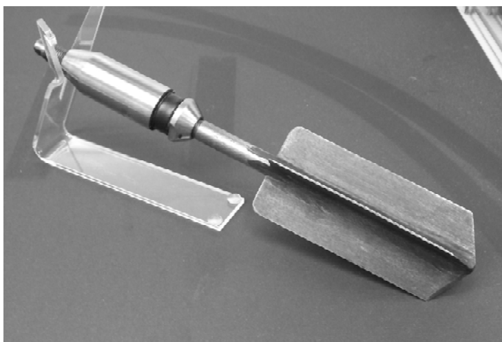
Figur 3. Vingborr med måtten 130 \times 65 \text{ mm}^2 för normal kohesionsjord. I fastare jordar används vanligtvis en vinge med dimensionerna 40/80.
