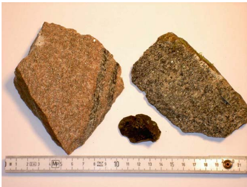
Figur 3.35, Stuffer från södra delen i Ö1, Gnejsiga granitoider (vänster, höger) och hornblände (mitten).
