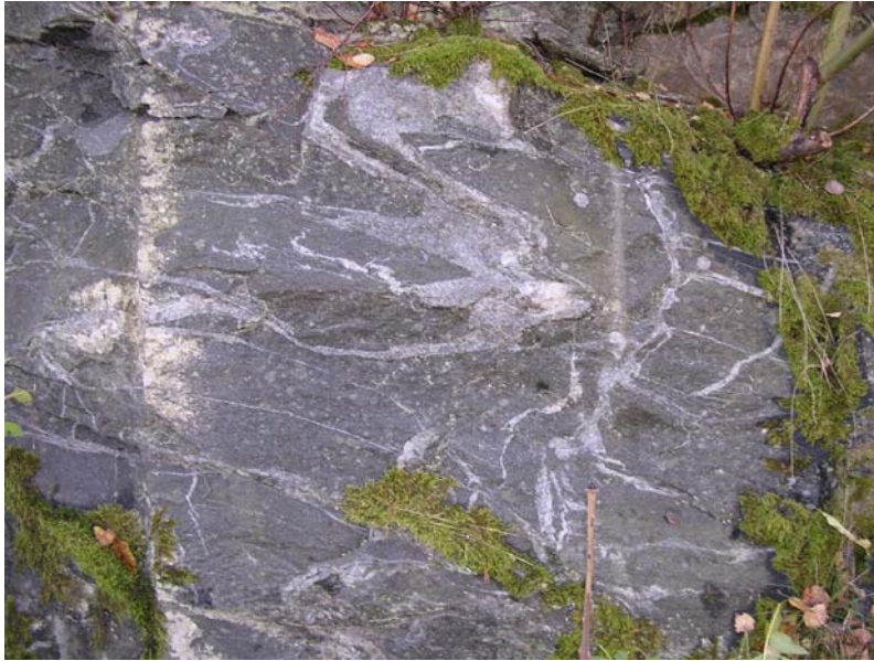
Figur 3.26, Bergskärning i delområde V1 med migmatitiskt struktur, delvis uppsmält, och tonalitisk sammansättning.
