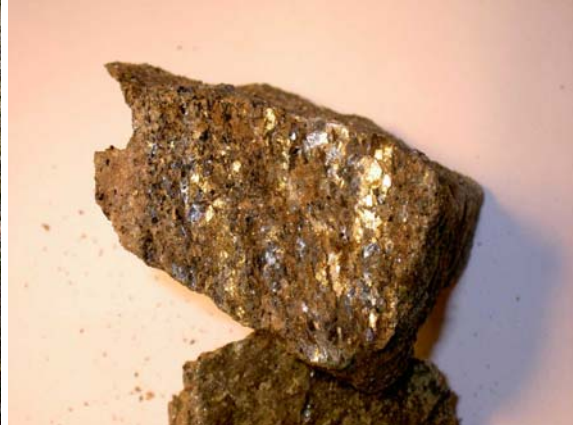
Figur 3.29, Bergets förgnejsade struktur. Figur 3.30, Muskovit i brottytan.
