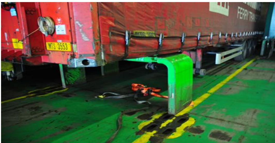
Figur 35 Trailer fäst i fartygsdäck med stålbock (V.Andersson 2014)
