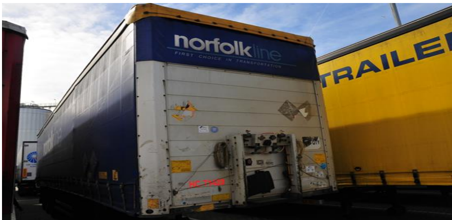
Figur 58 Rekommenderad placering av RFID-taggar trailerns kortsida
