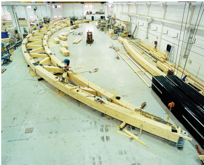
Bild 2 (Tillverkning av bågselement på Moelven Limträ, Moelv, Norge)
