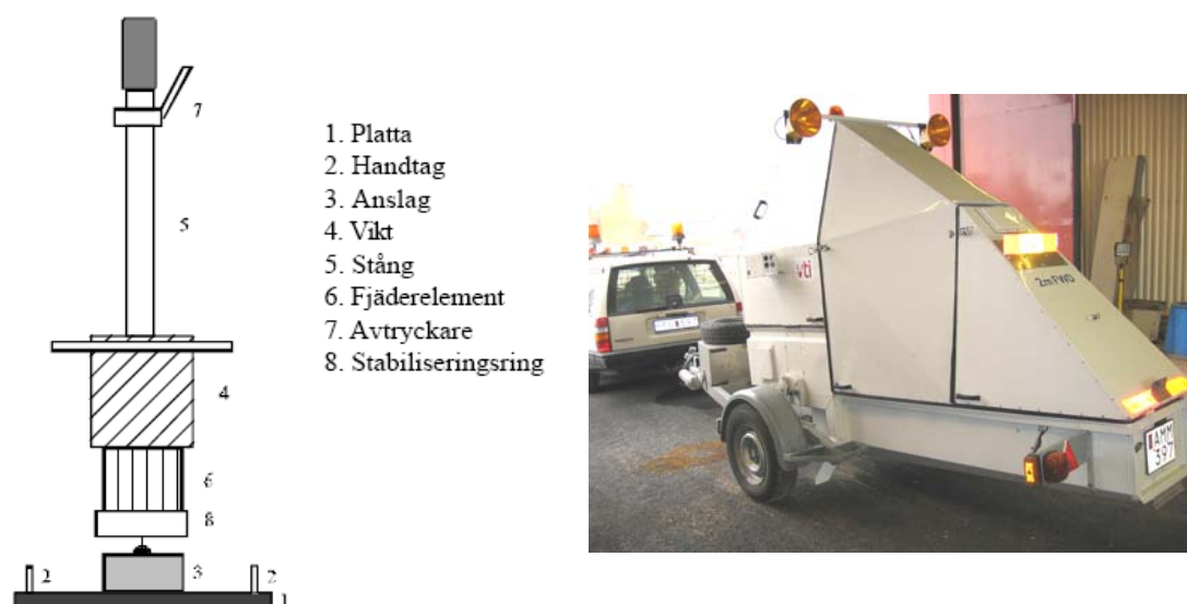
Figur 3.2 Bilderna visar principskiss över fallviktsapparat [10] samt fordonsmonterad tung fallvikt.
