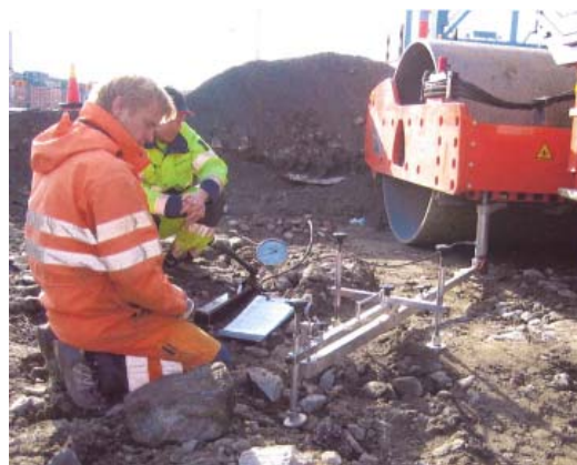
Figur 2.2 Plattbekastning med välten som mothåll.[5]
