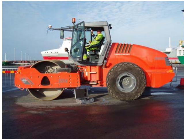
Figur 2.1 Välten som användes för packning och YPK.
