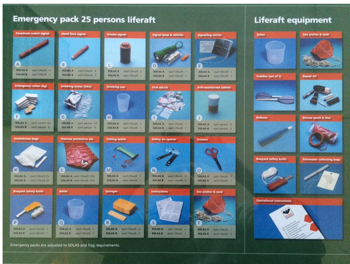
Figur 2-4 A-pack enligt LSA. Publicerad med tillstånd av Marcus Thiel - General Manager at VIKING Life-Saving Equipment Sweden AB
