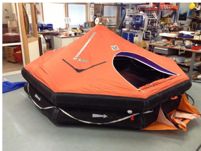
Figur 2-2. Överlevnadsflotte Viking 16DK. Bilden visar en 16-mannaflotte som förutom till storleken är identisk med övningens 12-mannaflotte. Publicerad med tillstånd av Marcus Thiel, General Manager VIKING Life-Saving Equipment Sweden AB.
