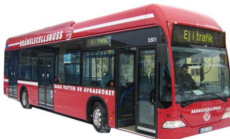
Figur 2: Bilden visar en av de tre vätgasdrivna bränslecellsbussar som trafikerade linje 66 på söder i Stockholm under perioden 2003-2005. Foto: Sven Wolf.
