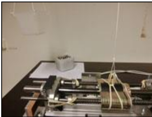
Figur 4-10 Konstruktion för att motverka friktionsbildning i motmassans glidyta.
