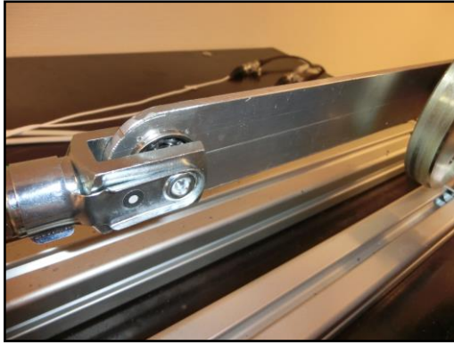
Figur 4-15 Lagrad led mellan svängarm och kolv
