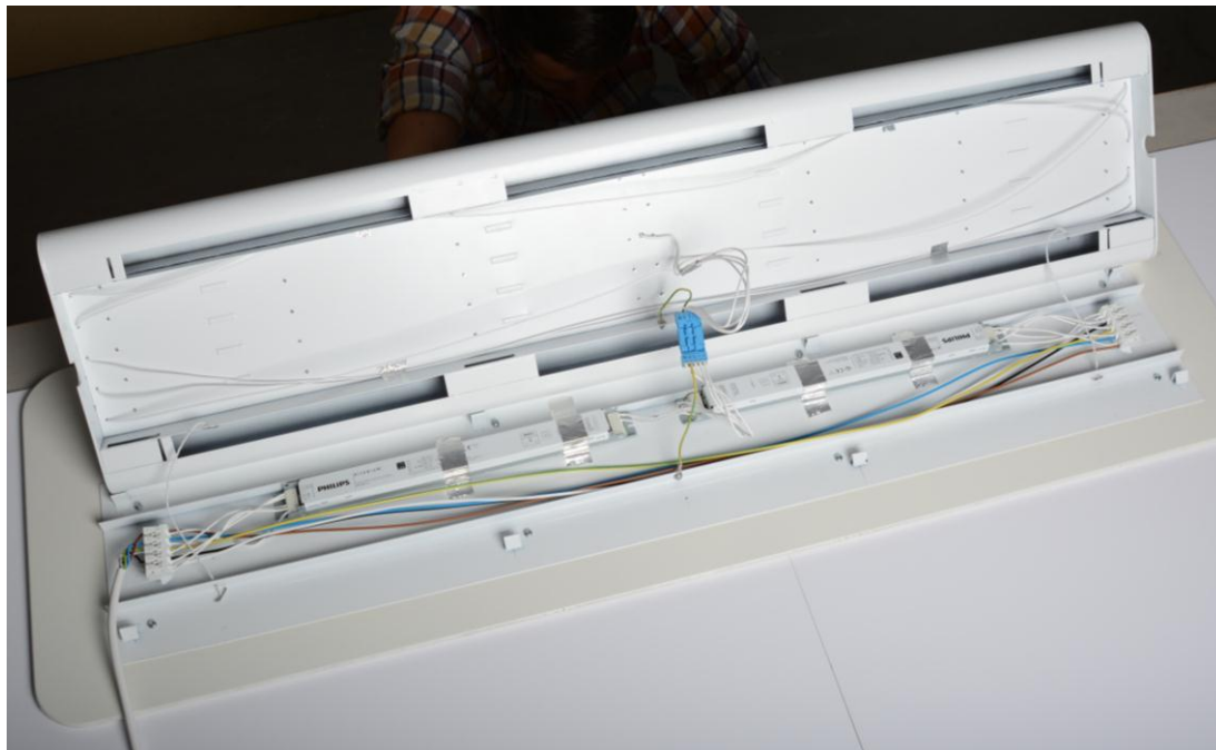
Fig. 6.2, Inside och koppling av prototyp i plåt.
