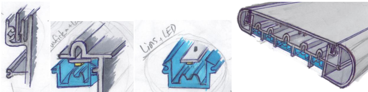
Fig. 5.10, Skiss av snäppfog, lins med snäppfunktion i spalt, linsens placering samt tvärsnitt.
