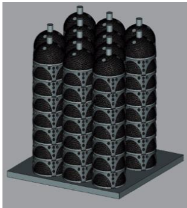
Fig. 4.1. Illustration av volymproduktion i en EBM-maskin (Arcam, 2014).
