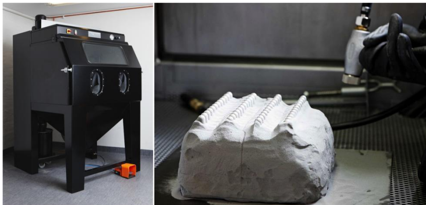
Fig. 2.3. PRS-maskinen används för blästring av bygghetaljer (Arcam, 2014).
