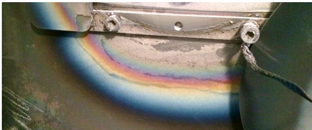
Fig. 7.2. Metallisering på dörren till vakuumkammaren.
