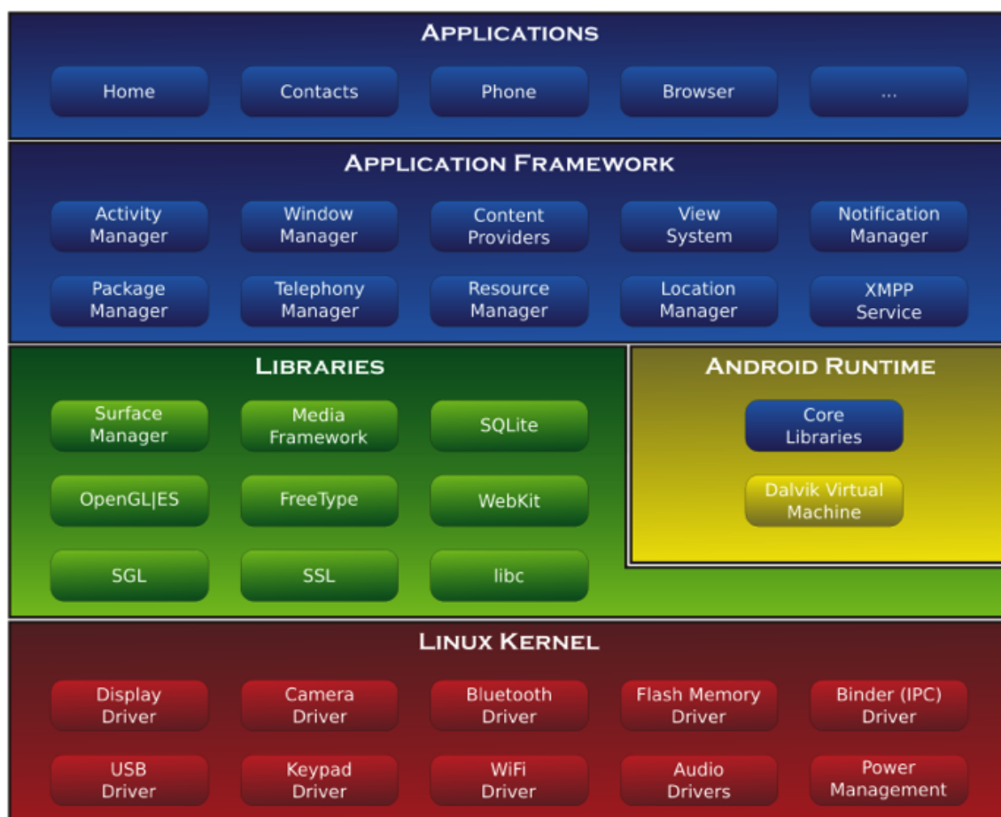
Figur 1: En illustration över de fyra separata lager som utgör Androids struktur: Linux Kernel, Libraries (inklusive Android Runtime), Application Framework och Applications. Bildkälla: Smieh 2012.
