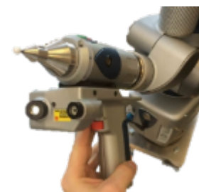
Figur 2-5 CMM-arm med monterad scanner-modul
