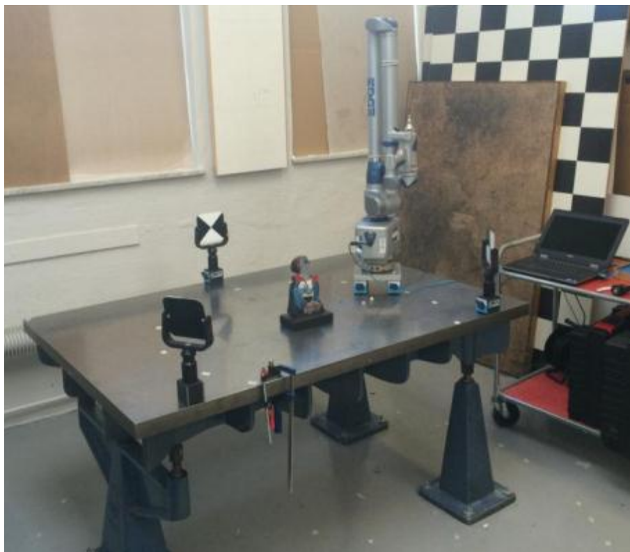
Figur 5-3 Uppställning för Circlemeasure med tre referenser
