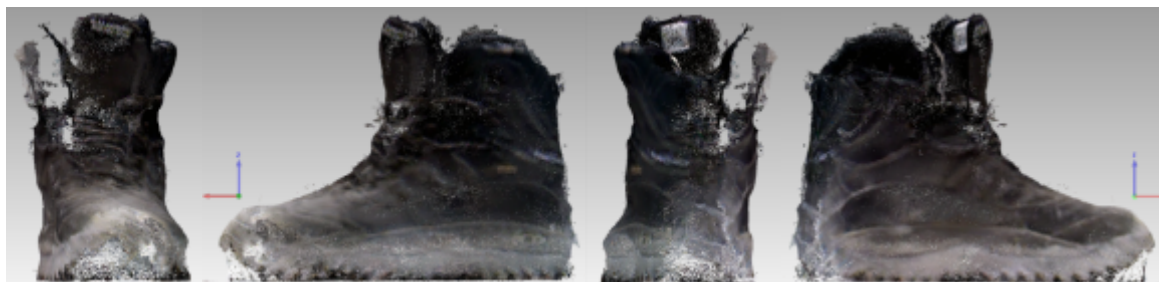
Figur 5-6 DPI-7-scanning på Kängan från 50cm avstånd med fyra referenser och av PHI3D optimerad data
