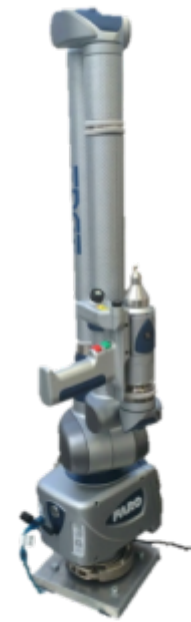
Figur 2-6 CMM-armen, som den användes
