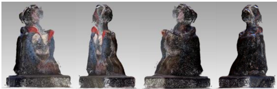
Figur 5-5 DPI-7-scanning på Picasso från 50cm avstånd med fyra referenser och av PHI3D optimerad data
