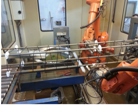
Figur 6 Maskin som najar ihop längsgående armering och tvärkraftsarmering (Börjesson 2014)
