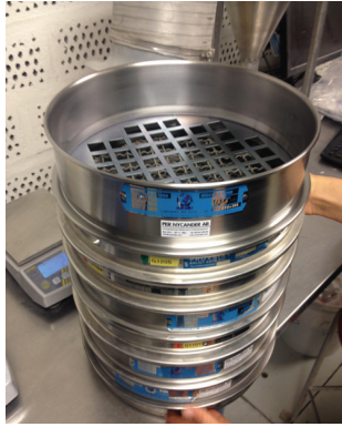
Figur 11.2 Bild 1: sikt med olika gallerstorlekar från 1-22,4 mm. Bild 2: Chips och förpackningsmaterial som fastnat i siktens galler.
