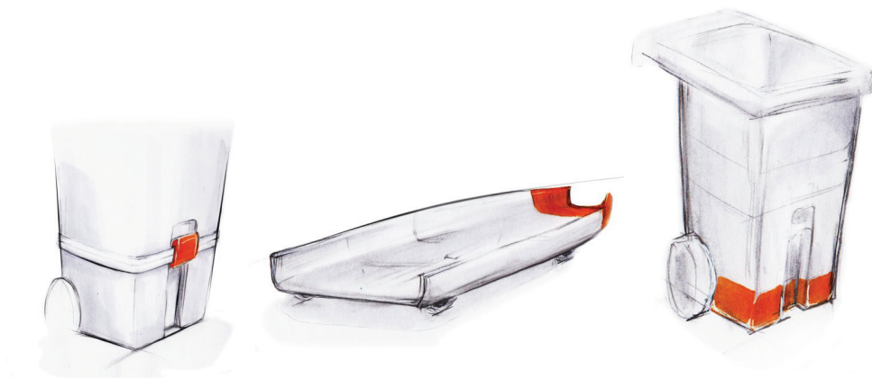
Figur 9.2 Övre bilden fr.v. Löstagbar botten för enkel rengöring, lågt kärl som placeras under packningslinjen, fettavstötande beläggning på insidan av tunnan.
