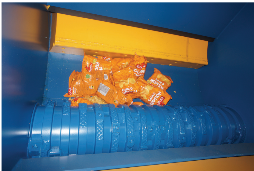
Figur 11.3 Produktavfall i uppsamlingsficka i destruktionskvarn, avfallet trycks mot den roterande (blå) axeln.
