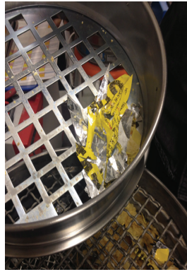
Figur 11.2 Bild 1: sikt med olika gallerstorlekar från 1-22,4 mm. Bild 2: Chips och förpackningsmaterial som fastnat i siktens galler.
