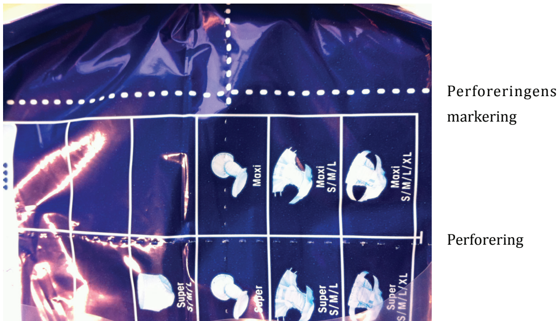
Figur 23, perforering och markering sammanfaller ej på förpackningen.
