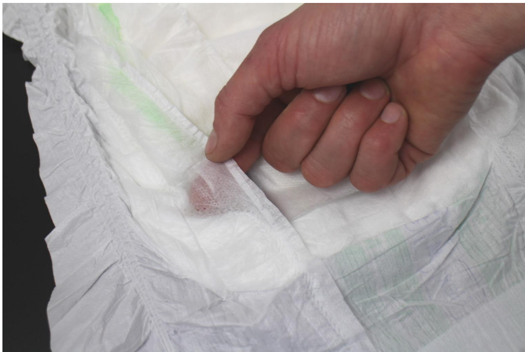
Figur 56. Exsert utformad efter den limfog som befintliga standing gathers i TENA Flex har.
