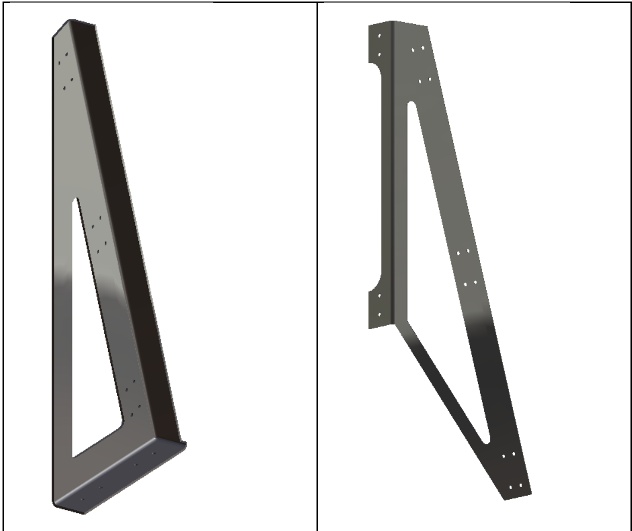
Figur 4.16 Slutgiltig design av golv- och luckkonsoler
