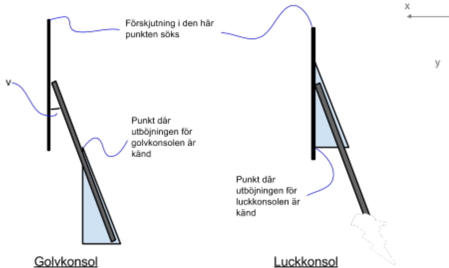
Figur 4.9 Schematisk bild över hur golv- och luckkonsolernas utböjning påverkar luckans förskjutning.
