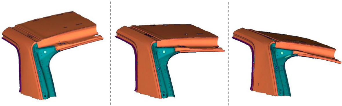
Figur 5.2 – Momentanbilder som visar hur nedböjningen av knuten i Animator ser ut. Bilden startar vid obelastat tillstånd och slutar vid full belastning.
