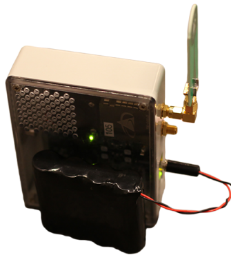
Figur 2.2: Ankare för lokaliseringssystemet bestående av en mikrokontroller och en RCM-antenn.
