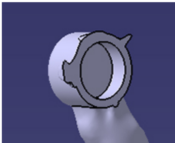
Figur 33: Hål för magnet skapat i CATIA.
