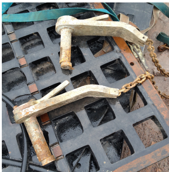
Figur 1.20: Lyftverktyg för Metsos käftkrossplattor.
