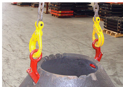
Figur 1.18: Mangasafe lyftverktyg för innermantlar [3].
