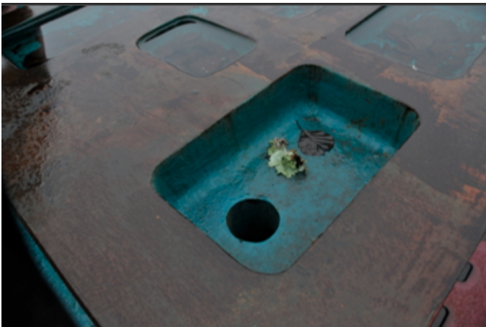
Figur 1.3: Lyftpunkt baksida krossplatta, Metso.
