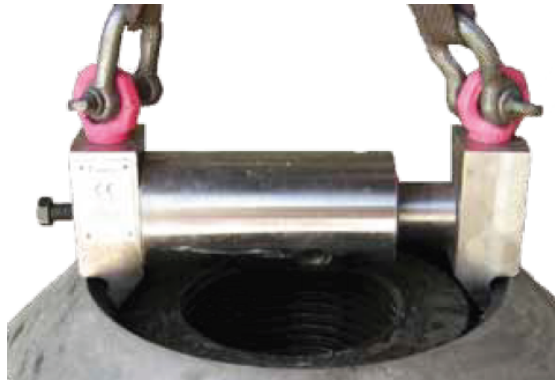
Figur 1.19: Lyftverktyg för Metso HP-modeller [10].
