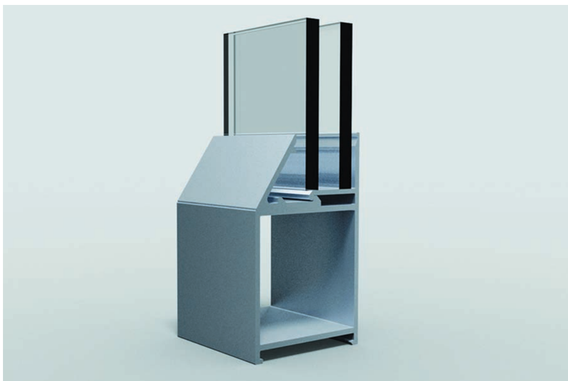
Bild 35 Visualisering av slutkoncept med 22 [mm] glastjocklek (dubbelglas)
