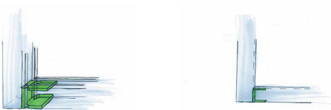
Bild 30 Konceptskiss "U-järn i spår"
