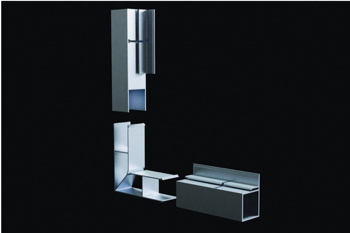
Bild 42 Visualisering av hörnförbindelse med alternativ kapning
