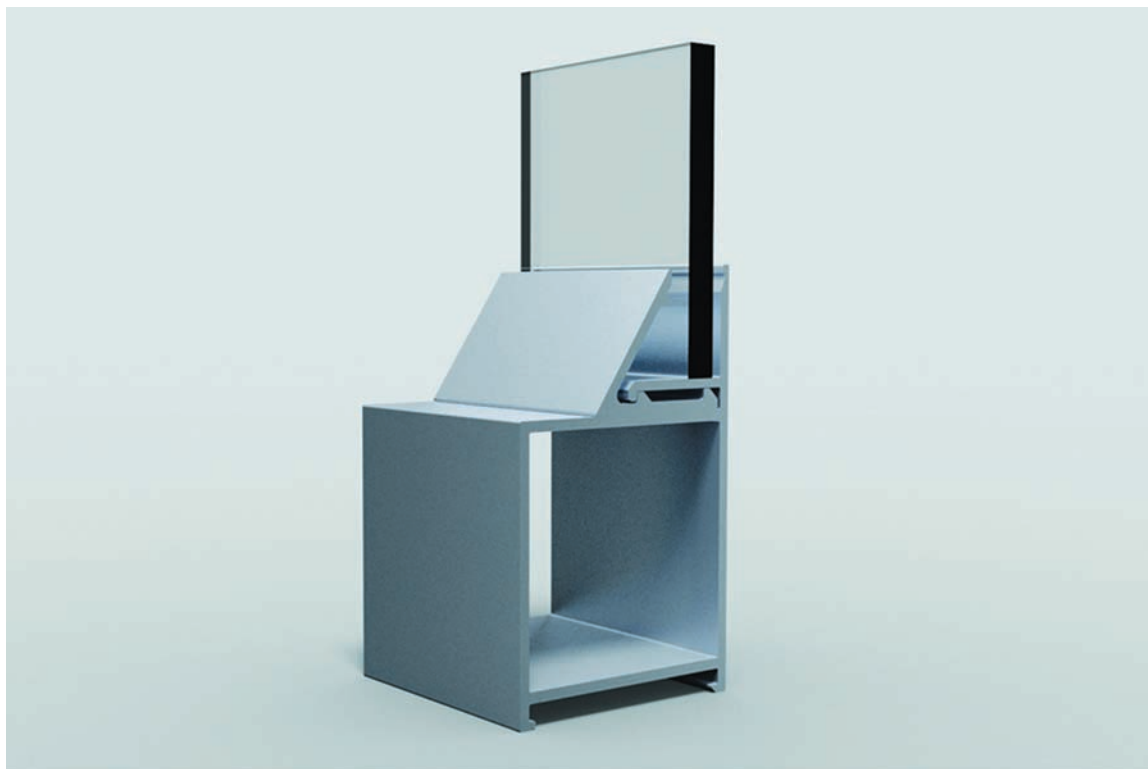
Bild 34 Visualisering av slutkoncept med 6 [mm] glastjocklek (enkelglas)
