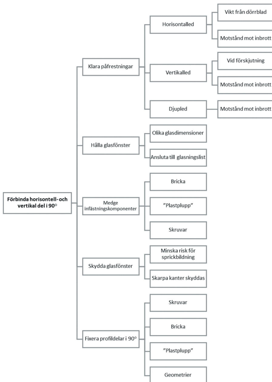
Figur 6 Funktionsanalys av hörnförbindning
