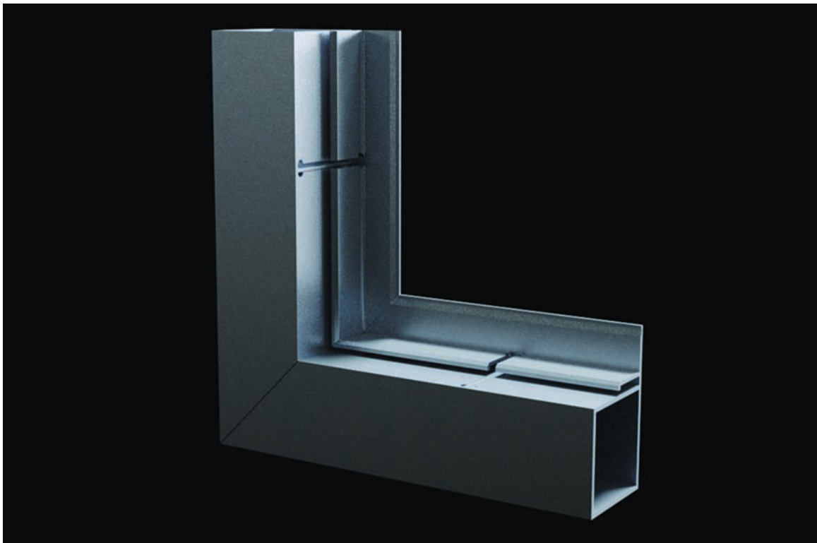
Bild 37 Visualisering på hur glasningsprofilen ser ut med tavelramshörn
