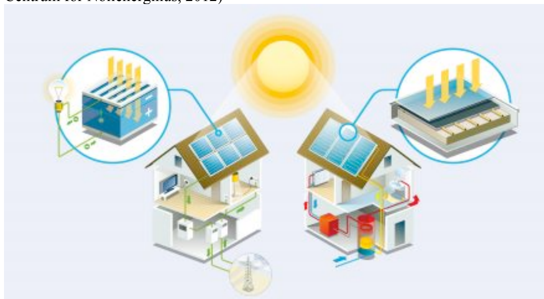
Figur 2: Exempel på elburen solkraft och vattenburen solkraft (Vattenfall, 2013).
