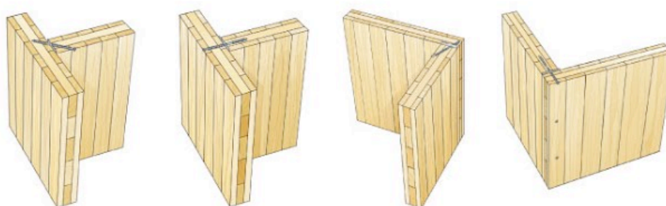
Figur 12: Tvärsnitt av hörnskarv mellan KL-trä element (Martinsons.se).
