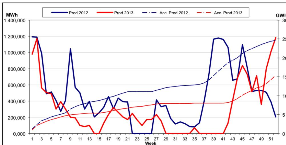
Figure 5.5: Electricity production in Haby and Hulta 2012 & 2013 (Borås Energi och Miljö, n.d. g).
