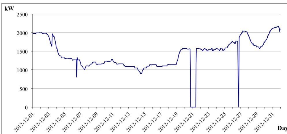
Figure 5.14: Electricity production in Axelfors, December 2012 (Borås Energi och Miljö, n.d. g).
