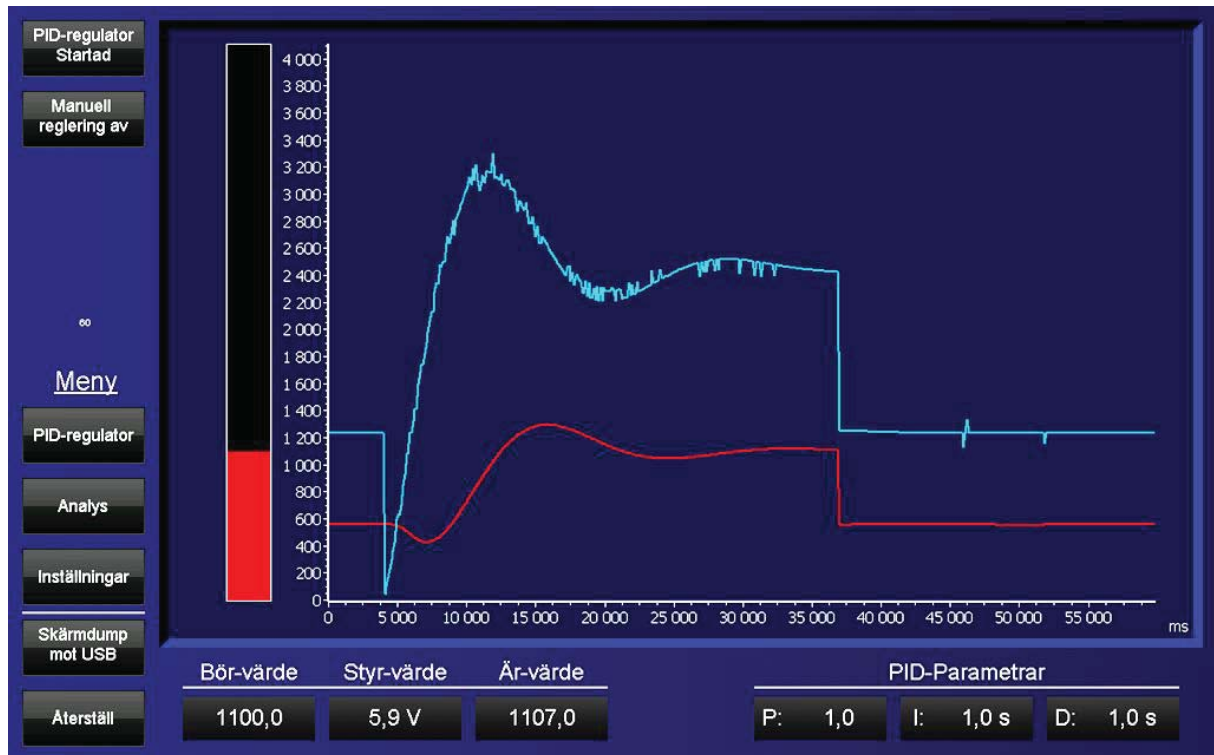
Figur 9.3 - Utseendet av sidan för PID regulatorn i HMI delen.
