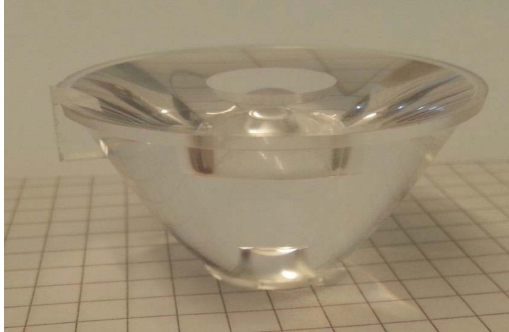
Figur 4-2 En av de TIR-linser som används till signallampan
