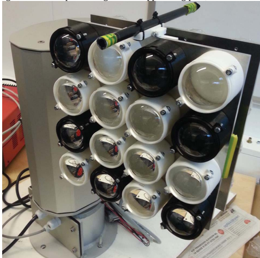
Figur 4-10 Robotarm med monterad asfärisk signallampa. Färgen på linshållarna har ingen betydelse.
