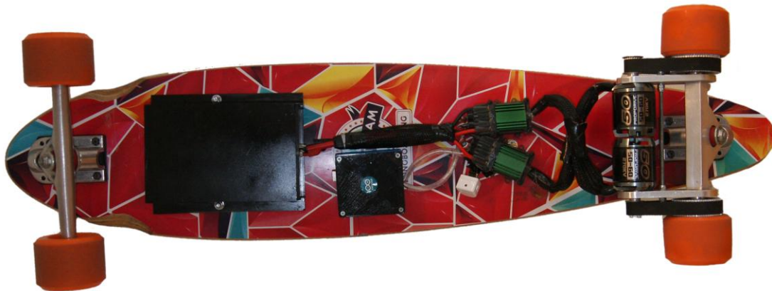
Figur 21 - Undersidan av longboarden som visar komponenterna hur de är placerade
