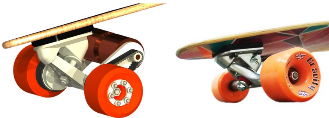
Figur 6 - CAD-modell av koncept på drivlinan t.v. och nuvarande truck t.h. De två bronsfärgade cylindrarna är longboardens två motorer. På bilden svänger longboarden för att bättre visa hur drivlinan ser ut och fungerar.
