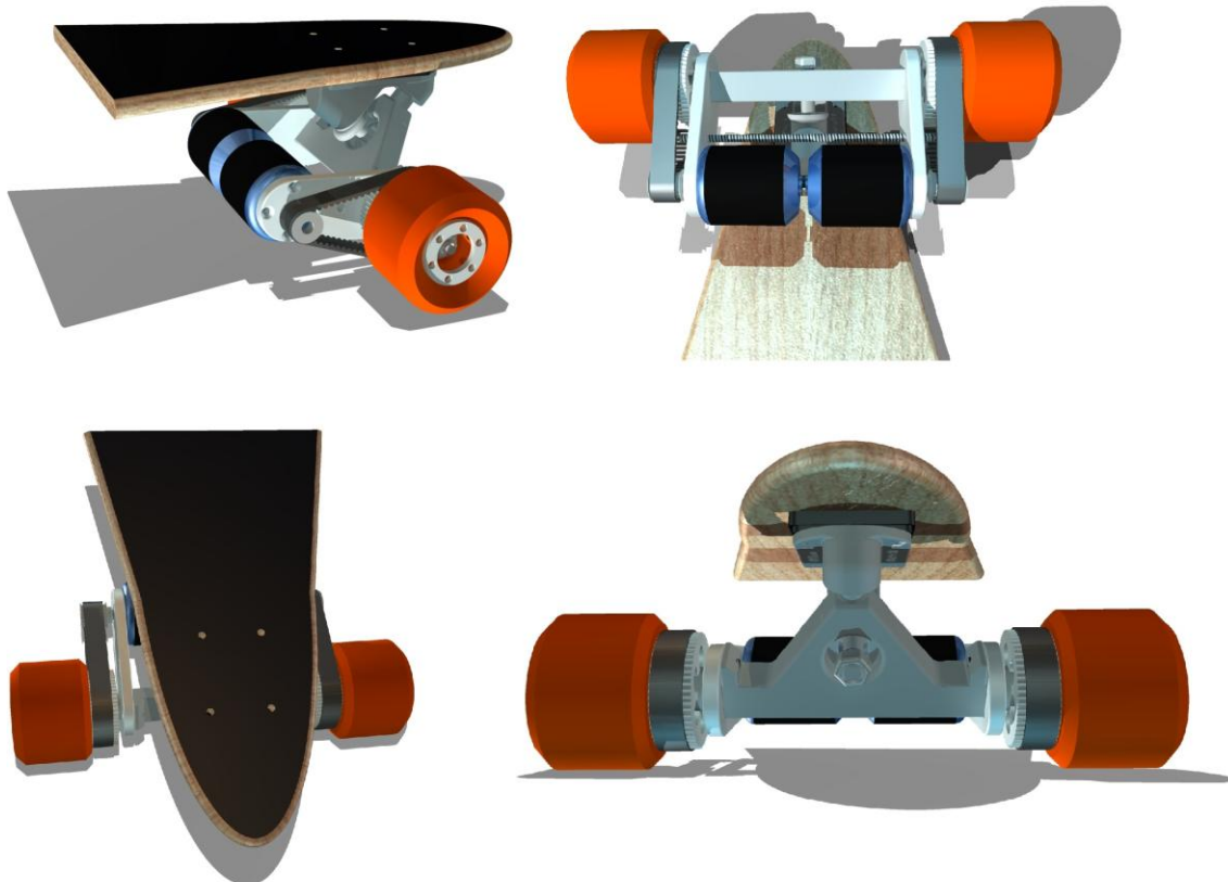
Figur 9 – Olika vyer och renderingar av drivlinan modellerad i Autodesk Inventor 2014
