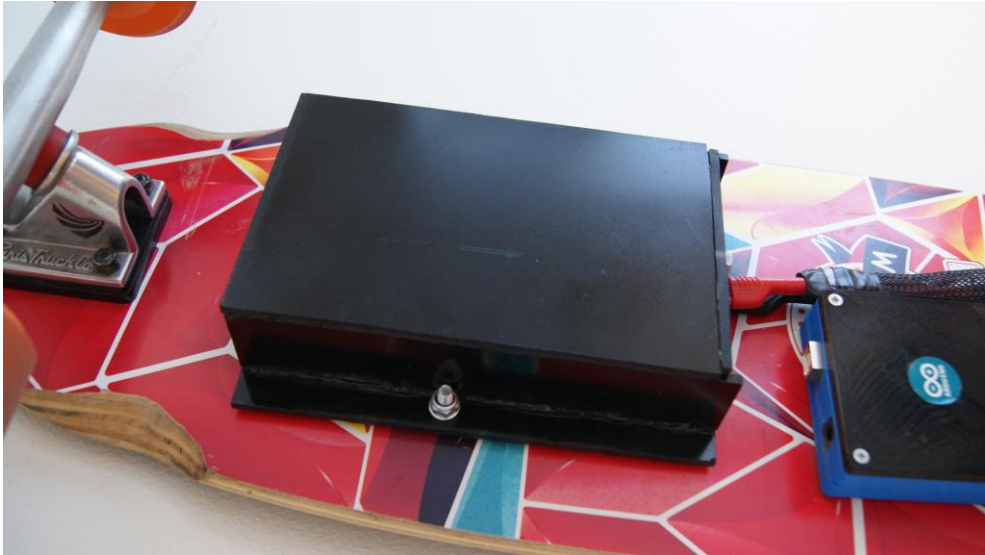
Figur 18 - Hur den färdiga lådan ser ut och fästs under longboarden och gjordes så låg som möjligt för markfrigången
