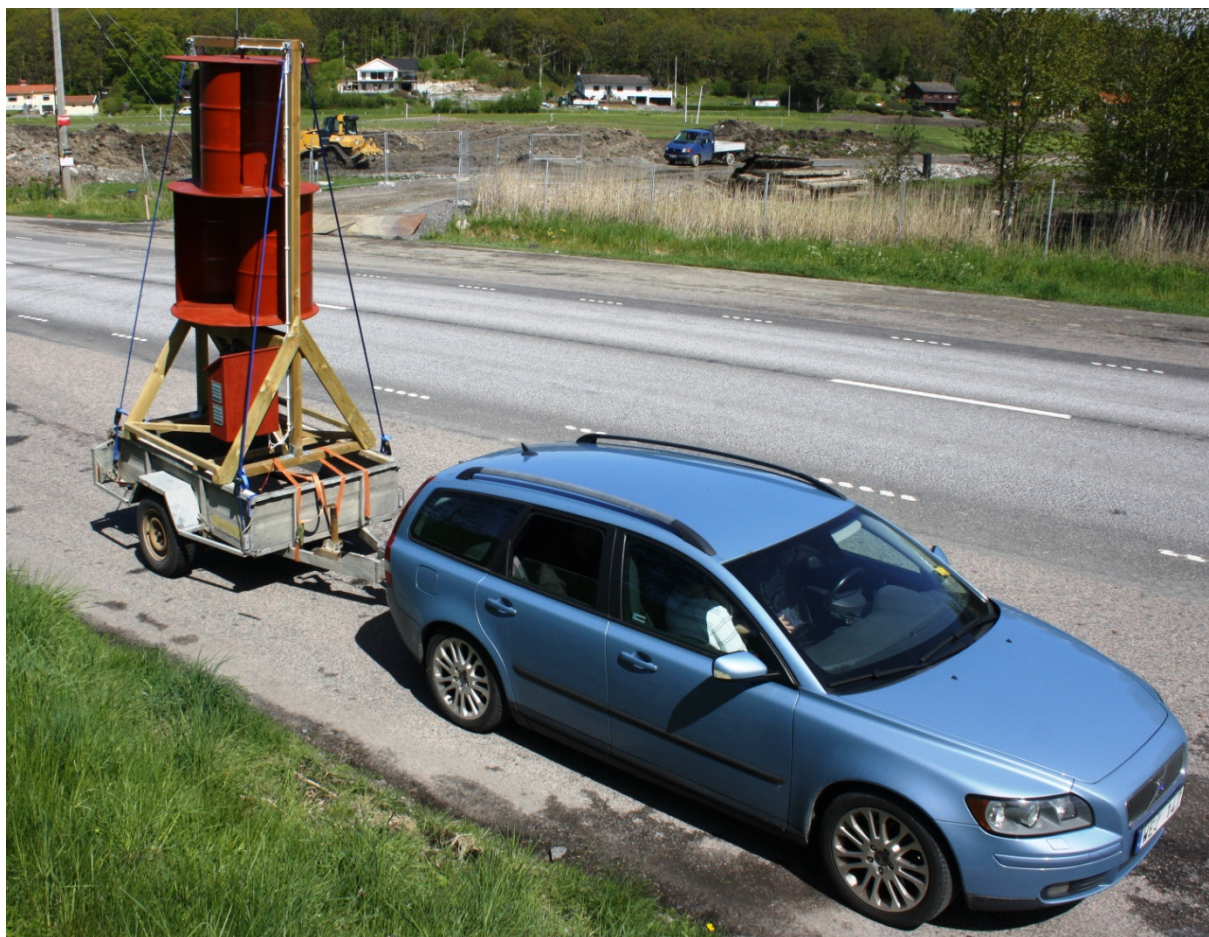
Figur 8.4. Vindkraftverket monterat på släpkärra kopplad till en bil.
