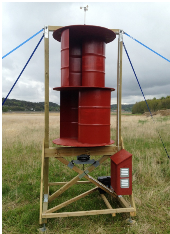
Figur 2.2. Savoniusvindkraftverket med turbinen monterad i ställningen, vindsensorn överst samt elektronikenhetens skyddande hus ner till höger. Generatorn syns under turbinen.
