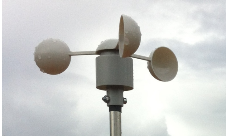
Figur 5.13. Vindgivaren som användes för att mäta vindhastigheten.
