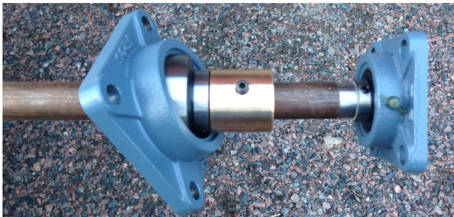
Figur 3.4. Lagren är fästa i axeln med distanser för att passa ihop med de olika dimensionerna.
