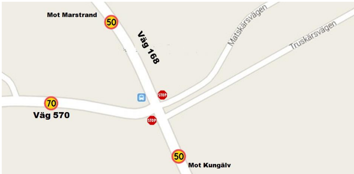
Figur 11: Närbild över korsning 1. Här syns tydligt korsningens utformning med två mindre vägar anslutande från nordost och väg 570 i väst, vägen benämns ändå som en fyrvägs korsning.
