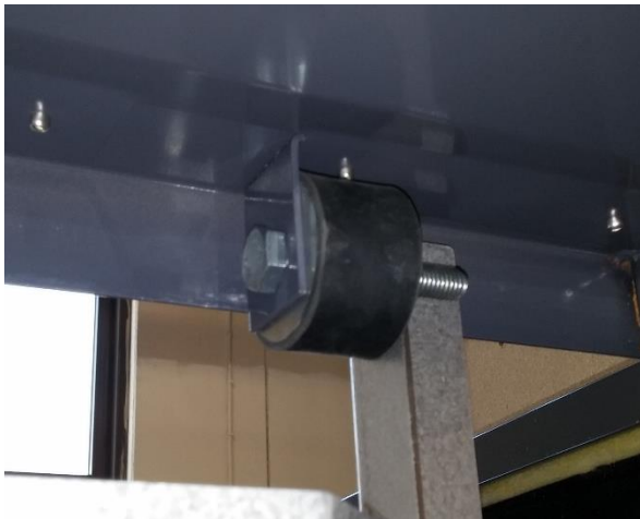
Figur 7. Övre upphängningsdämpare för innerramen.
