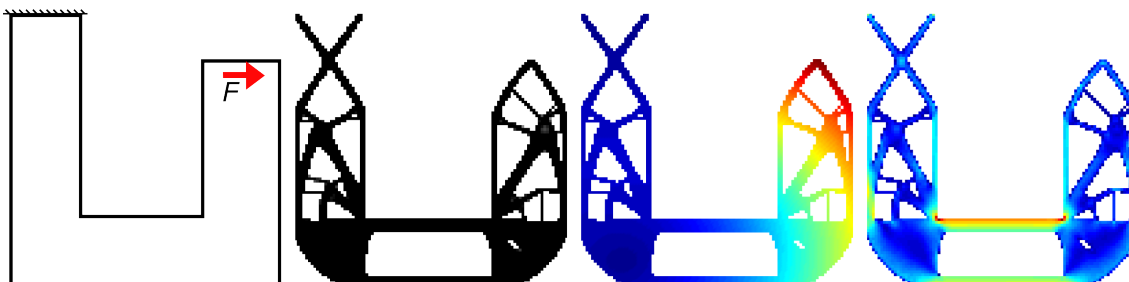
Figur 4.9: Demonstration av topGUI. Från vänster visas först domänen med stöd och krafter, sedan den optimerade strukturen, sedan totala utböjningar och till sist effektivspänningar enligt von Mises.
