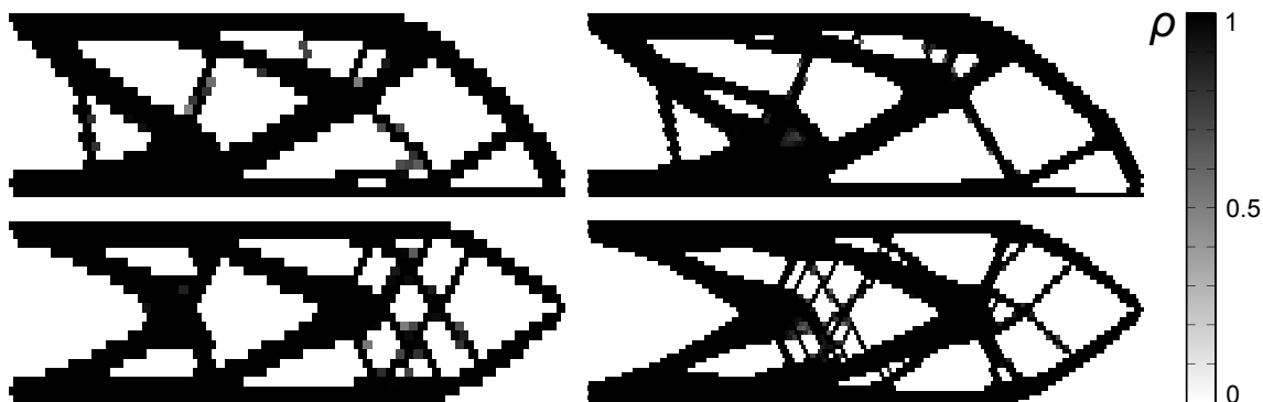
Figur 4.4: Optimerade strukturer med förskjutna Q9-element för MBB-balk (överst) och konsolbalk (nederst) med nätupplösningar 60x20 (vänster) respektive 120x40 (höger).
