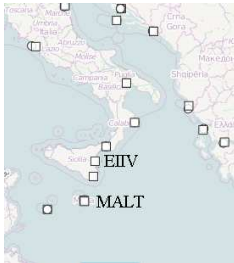
Figur 5: I denna karta är GNSS-stationerna nära Etna, tillhörande nätverket SONEL markerade som kvadrater. Av dessa uppfyllde två stationer, EIIV och MALT, kraven på att befinna sig i rätt område och spara SNR-data. Etna befinner sig precis norr om EIIV i figuren. Originalbild från [42].
