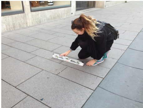
Figur 9: Mätning av lutning med hjälp av ett elektroniskt vattenpass
