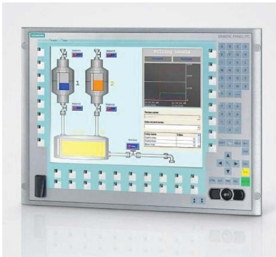
Figur 7: Exempel på en operatörspanel (8)
