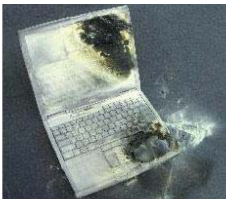
Fig 44. Ett LJB som orsakat skada på en laptop. Enligt Sony kan anledningen till termisk rusning vara förorenade mikroskopiska partiklar av Fe, Cu, Ni eller Al. Isidor Buchmann har framställt figuren och Cadex Electronics Inc. har givit tillåtelse att använda den(56).
