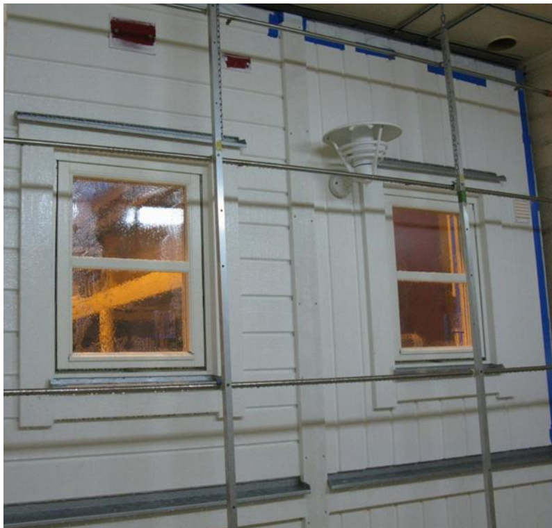
Pågående slagregnsprovning av träfasad med detaljanslutningar
