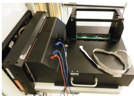
2.7 Fixtur att montera kretskort i som ska testas i kretskortstestaren
