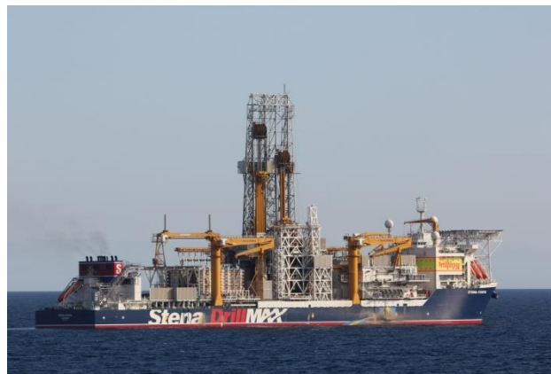
Figur 6. Borrinstallation byggd på ett konventionellt fartygsskrov (Dahlgren, 2010b)
