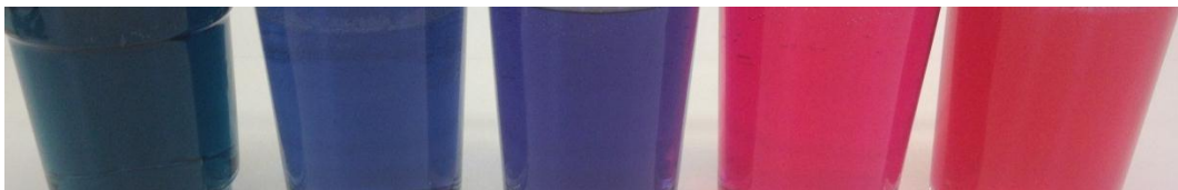
Bild 4 Lösningar med olika livsmedel färgade med rödkålsindikator. Bikarbonat, socker, vatten, vinäger, citron
