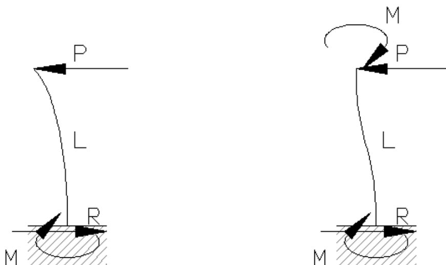
Figur 4.5 Bilden till vänster visar en beräkningsmodell för bulten med fast inspänning vid dess nedre del och bilden till höger visar en beräkningsmodell med fast inspänning vid bultens nedre del och förhindrad rotation vid dess övre del.
