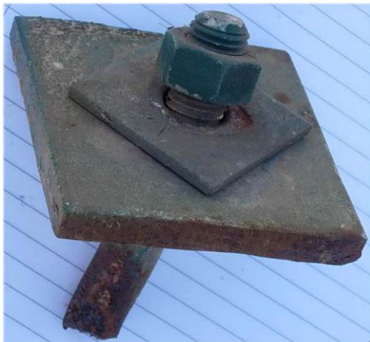
Figur 4.1 Den brustna förankringsbulten inklusive låsningsbricka.
