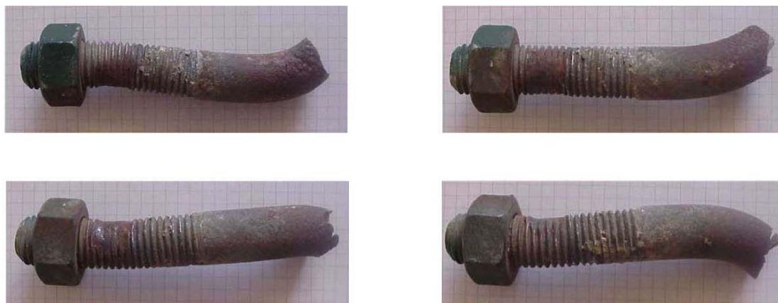
Figur 4.3 Förankringsbultens deformerade form visad från fyra olika håll. Bulten vrids cirka 90° mellan de olika bilderna.
