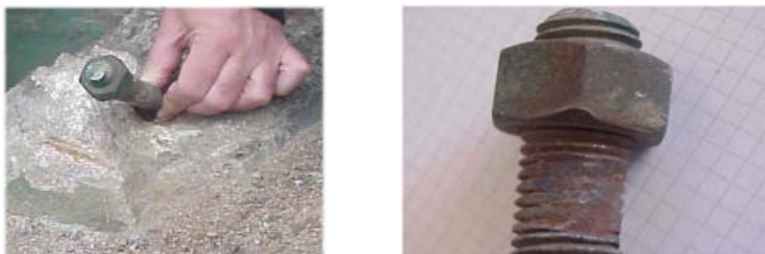
Figur 4.4 Bilden till vänster visar hur bulten återplaceras i den befintliga undergjutning och bilden till höger deformationer i bultens gängade del vid låsningsbrickans placering.
