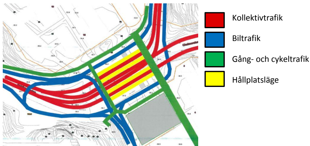
Figur 11 - Förslag på ombyggnad av hållplats Chalmers (Andersson, 2012).
