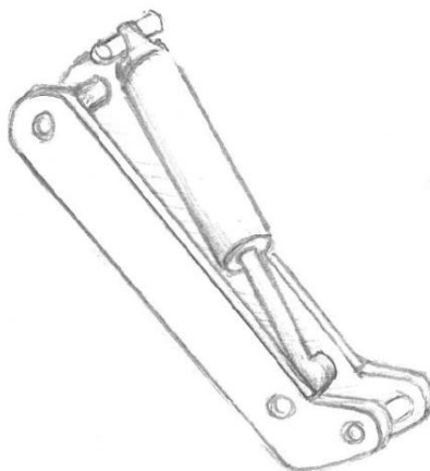
Fig. 9.4.3 Lyftcylindern infästning placeras inuti lyftarmen
