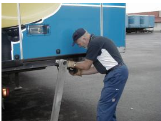
Fig. 5.3.2 a) Nedfällning av stödben b) Avställning av flak
