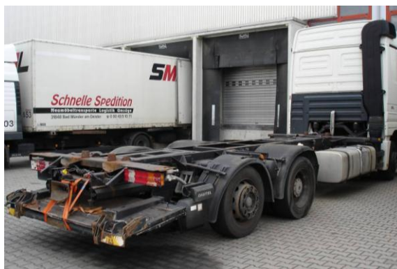
Fig 5.7.2 Sönderkörd bakgavellift, notera att bilen ej har undermonterat drag
