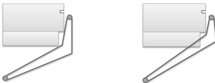
Fig. 9.4.1.2 a) Lyftarm utformad för att komma nära intill flakets golv b) Lyftarm placerad innanför styrtunnel
