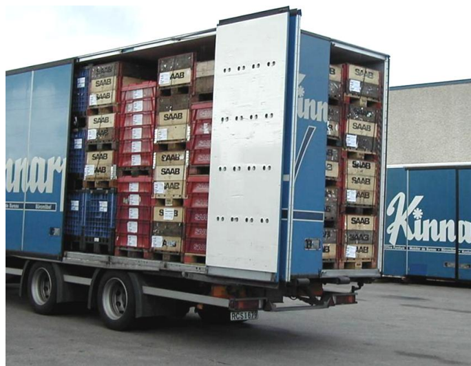
Fig. 5.2.2.3 Fullastat skåp med öppna sidodörrar
