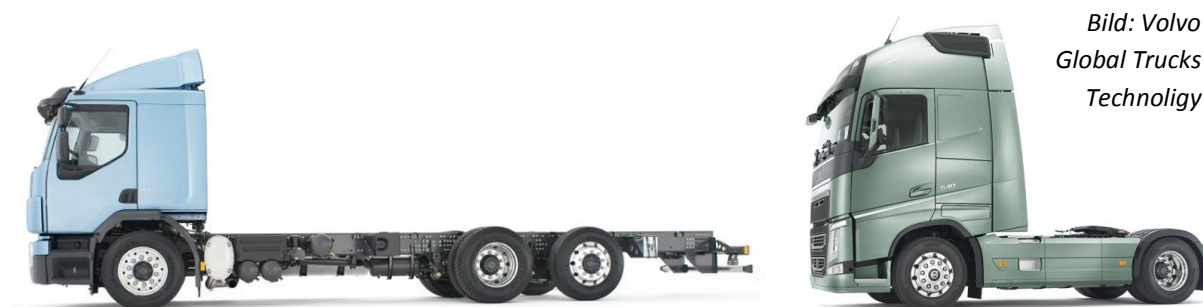
Fig. 2.2.1.1 a) Jämnlastbil b) Traktordragare
