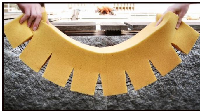
Figur 19. Modell av armerad betongbalk i nedböjt läge
