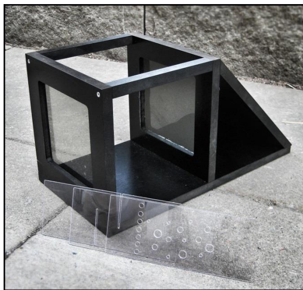
Figur 9. Ljuslåda med polariserade filter och skivor av polykarbonat
