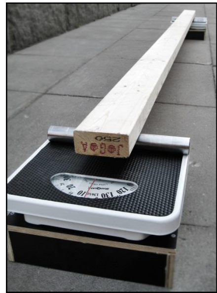
Figur 16. Uppställning med plank, våg och rullstödet
