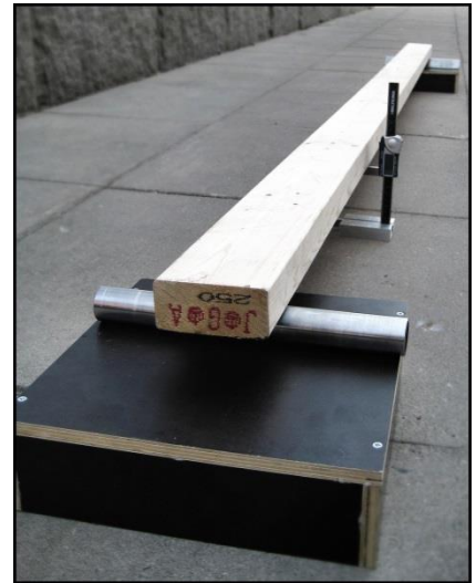
Figur 18. Uppställning med digitalt skjutmått
