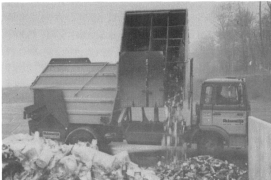
Fig 7.3 Skånemiljös första fyrkammarsfordon "Ekorren I" konstruerad 1980/81.
