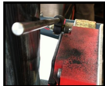
Figur 2.1. Bild på en av testlabbetts mekaniska ändlägesgivare.
