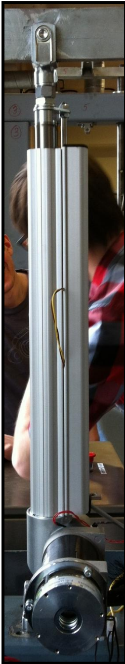
Figur 4.5. Ställdonet med BLDC-motor och två ändlägen (givare under kåpa).
