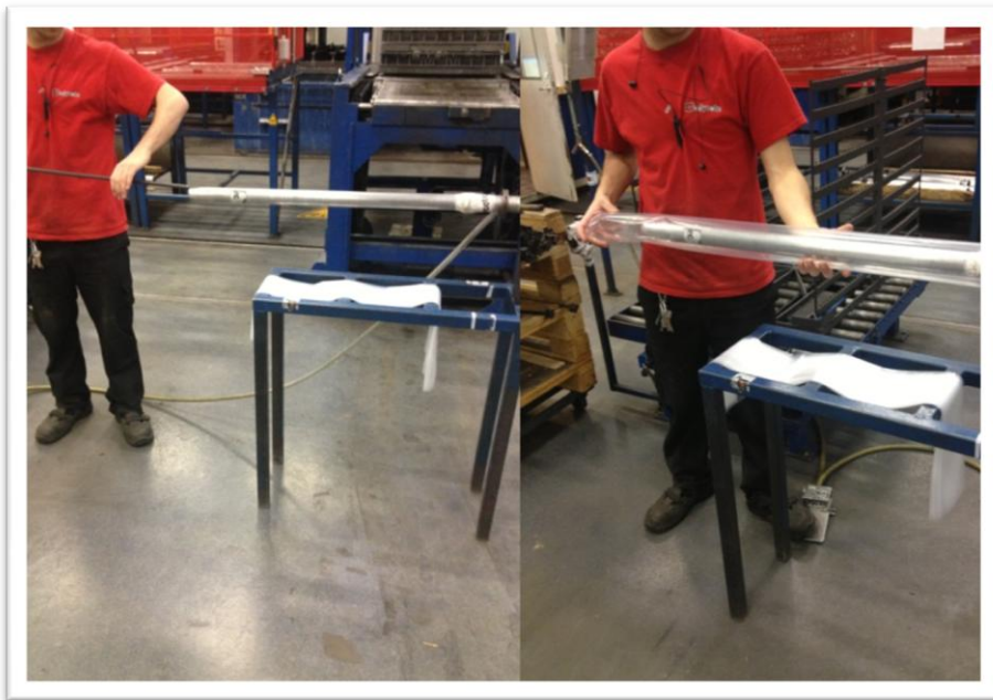
Figur 4.6 Till vänster träs hållarna av pinnen och på tryckluftstuben. Till höger ser vi operatören starta tryckluften med en fotpedal som då blåser upp påsen och gör det lättare att trä den över hållarna.
