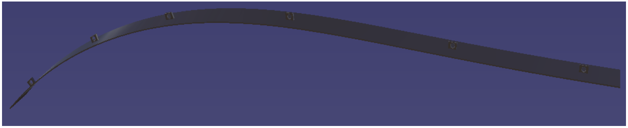
Figur 7.18. En bild snett bakifrån på den längre flottörramen med utstickande fyrkanter som har hål i sig för att kunna fästa flottören med hängare.
