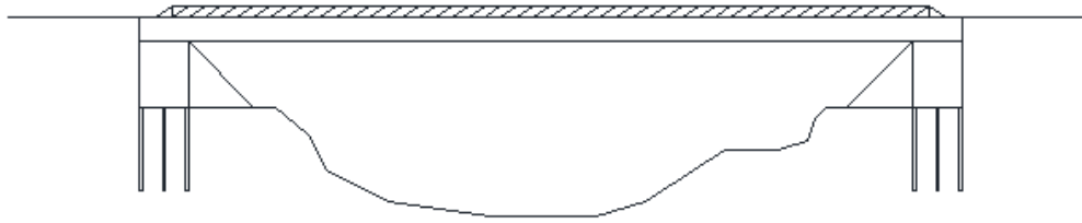
Figur 22: Skiss från sidan på Brokoncept 1, en spännarmerad betongbalkbro med lådtvärsnitt.
