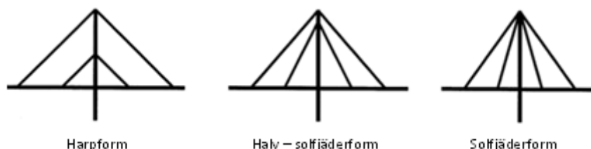
Figur 18: Bild över stålakablarnas olika formationer på pylonerna. Olika formationer ger olika reaktioner i konstruktionen.
