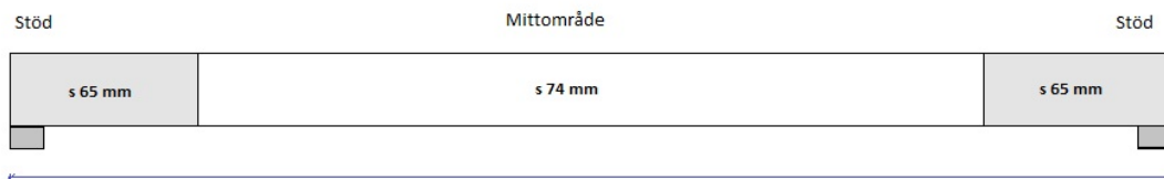
Figur 12-11. Balken indelad i delområden med olika armeringsintensiteter (Egen bild).
