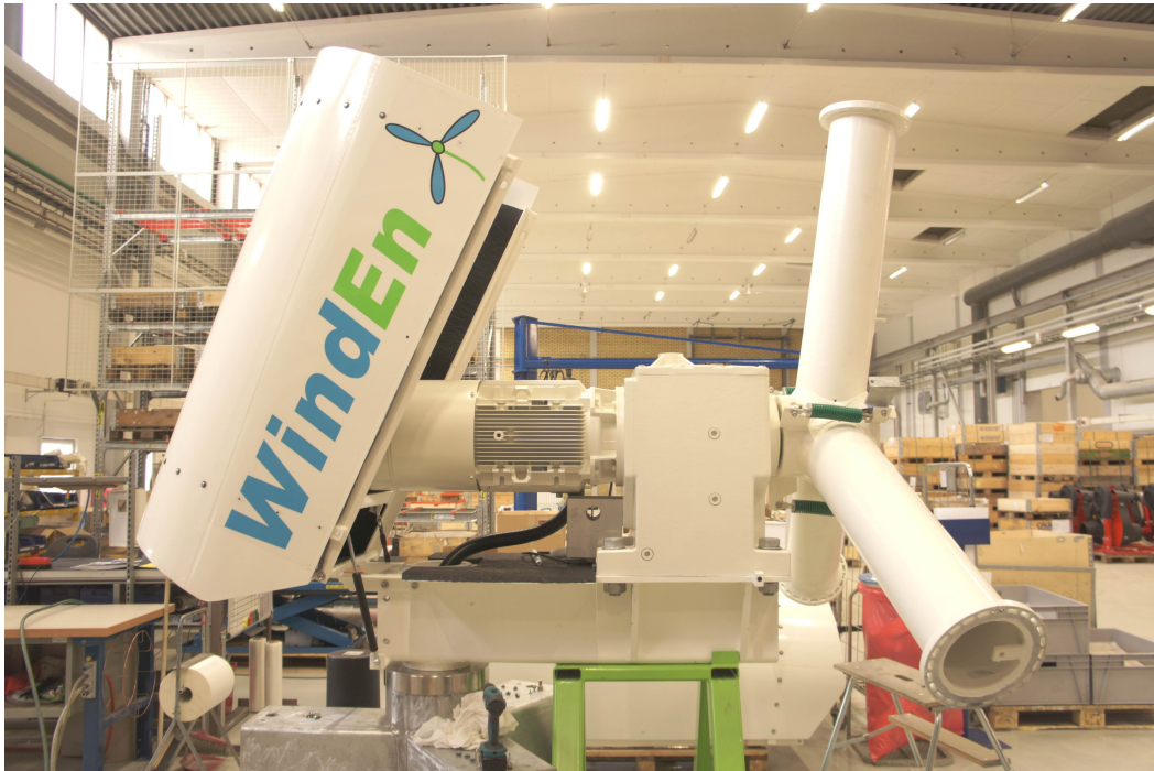
Figur 2 Bilden visar en monteringsstation för WindEn 45 på UFABs fabrik.
